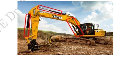
Fig. 3.34: Hydraulic actuator
