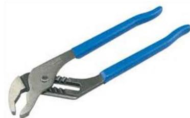
Fig 2.30 Water-Pump Pliers
