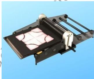
**Fig 1.33 Die cutting machine**
