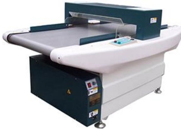
*Fig.: 2.4 Needle detectors*
