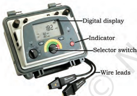
Fig. 7.25 Electronic megger meter
